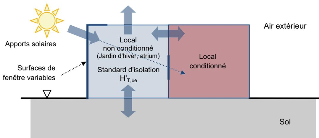
Figure 8: Schéma du modèle permettant d'analyser l'impact des zones non conditionnées exposées aux rayonnements solaires sur le bilan énergétique thermique
