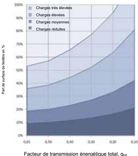
Classification en profils de charge en fonction de la protection solaire et de la surface de fenêtre rapportée à la surface de plancher nette de la zone non conditionnée
